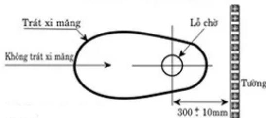
**2. Kiểm tra kích thước lắp đặt:** Kiểm tra kích thước bồn cầu, khoảng cách từ tường tới tâm ống thải, đường kính ống thải và lỗ cấp nước.
